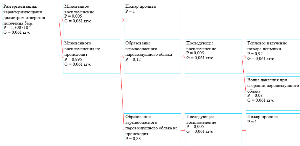
Рисунок 1 – Дерево развития пожароопасных событий для инициирующего события Разгерметизация, характеризующаяся диаметром отверстия истечения 5мм
