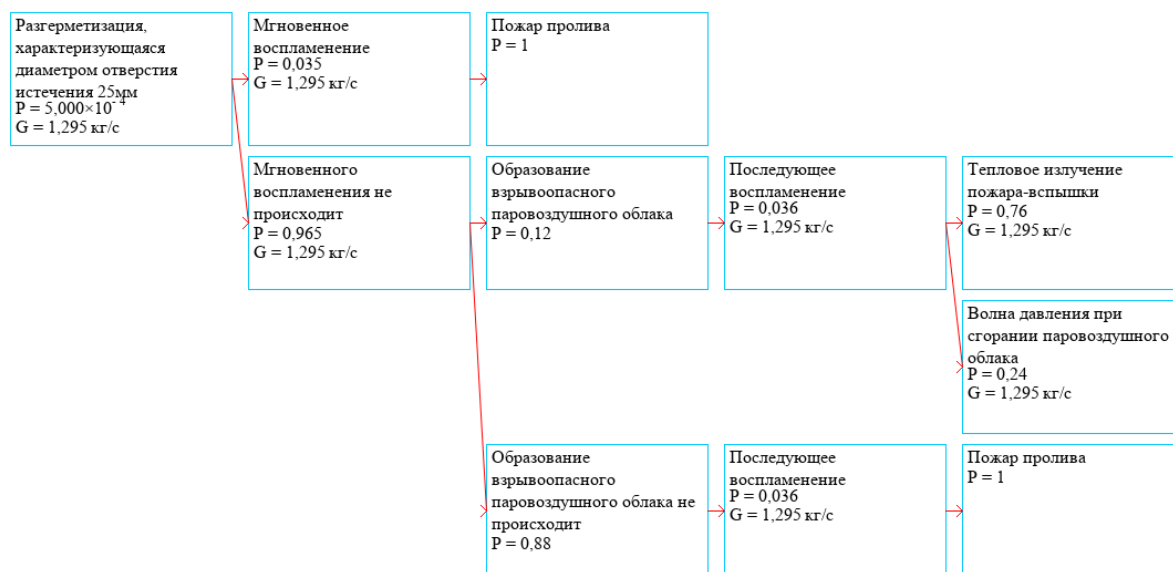
Рисунок 37 – Дерево развития пожароопасных событий для инициирующего события Разгерметизация, характеризующаяся диаметром отверстия истечения 25мм
